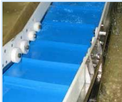
Nastro SuperDrive™ con profili che lavora in immersione
