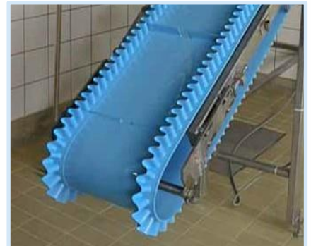
Nastro SuperDrive™ con bordi di contenimento e profili speciali
