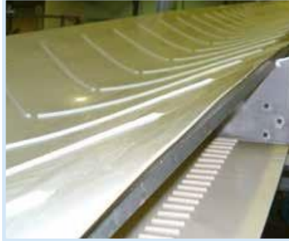
Nastro SuperDrive™ in conca con profili Chevron
