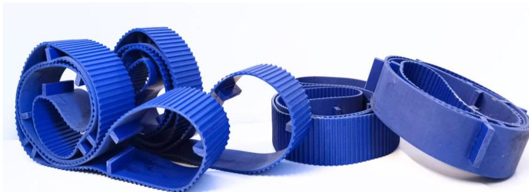
Le cinghie dentate transfood sono realizzate completamente da processo di estrusione con un materiale omogeneo (sia i denti che la struttura del dorso vengono estrusi e diventano un corpo unico). Questo processo produttivo rende possibile la costruzione di una cinghia con cavi di rinforzo in kevlar, senza nasello e con bordi sigillati, ideale per essere utilizzata nell'industria alimentare e per il contatto con alimenti.
